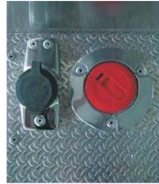
Слева направо: а) розетка для включения ходового огня б) заливная горловина топливного бака
