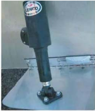
Электрическая трансцевая плита.
