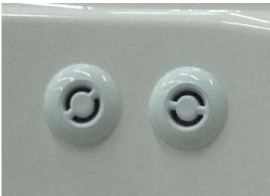
Вентиляция топливных баков.
